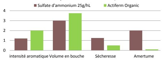
Essai Sauvignon Blanc – 2010 : N ass : 70 mg/L – Turbidité 80 NTU – pH 3,3. Comparaison de l'effet de 25 g/hL de sulfate d'ammonium ajouté au levurage et 40 g/hL d'ACTIFERM OR apporté en 2 fois au levurage et à mi FA sur la cinétique de la FA d'un moût carencé et sur la dégustation.
